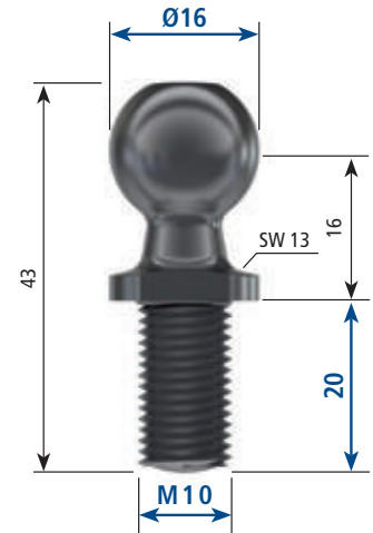
2054QF Clear passivated / Klar passiviert
